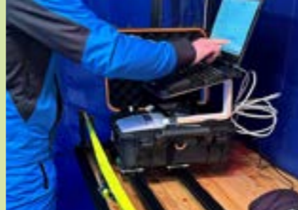
Mobiele unit voor het testen van de ski's op fluorhoudende waxen.
